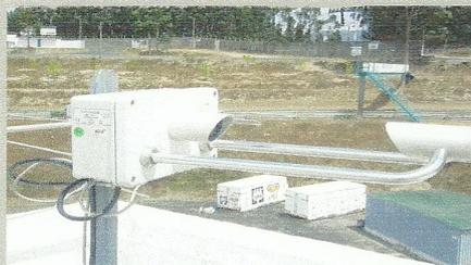
Figura 2. Disdrómetro óptico THIES Laser Precipitation Monitor
